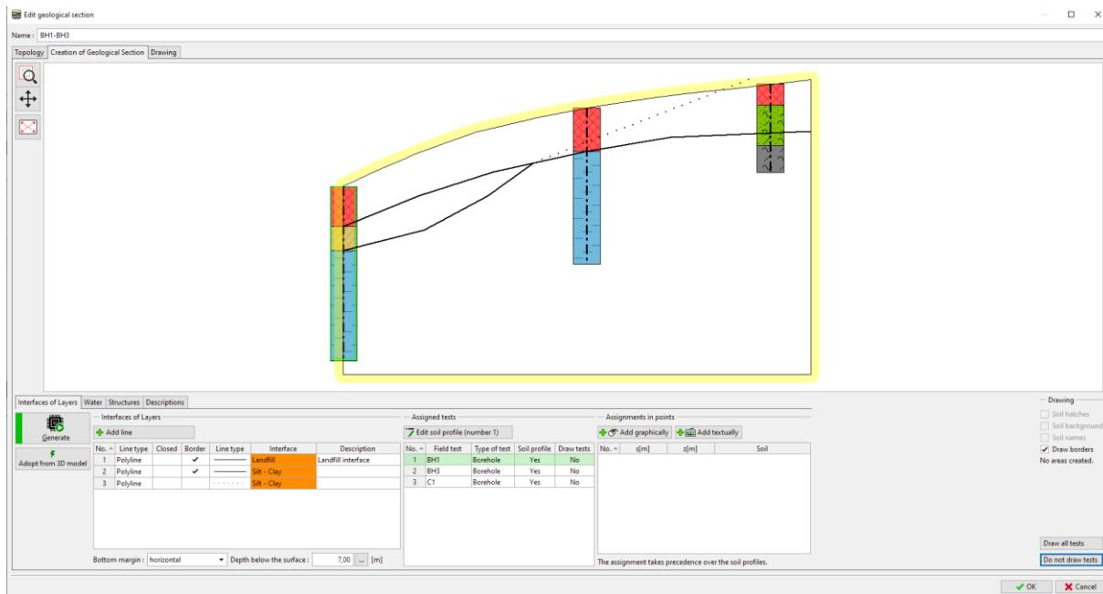
Vamos inserir a falha – adicionar uma nova interface e selecionar a opção “Falha”.
