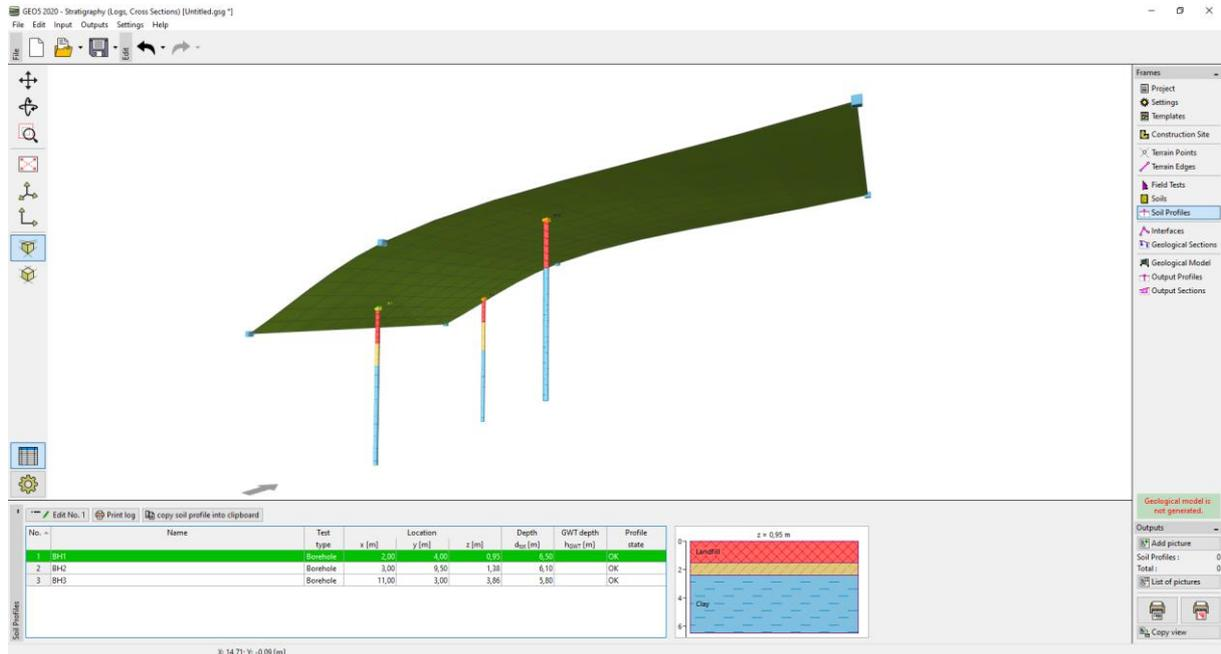
*Nota: A razão para a existência de Perfis do solo é semelhante à dos “Solos”. É necessário simplificar sondagens complexas e detalhadas para o modelo geotécnico. Ensaio de penetração (CPT, SPT) também podem ser interpretados como perfis geológicos. Isto pode ser feito nesta janela ou ao criar secções geológicas. A criação de perfis do solo a partir de ensaios de campo está descrito no Manual de Engenharia No. 43 – Criação de perfis do solo a partir ed ensaios de campo.*
