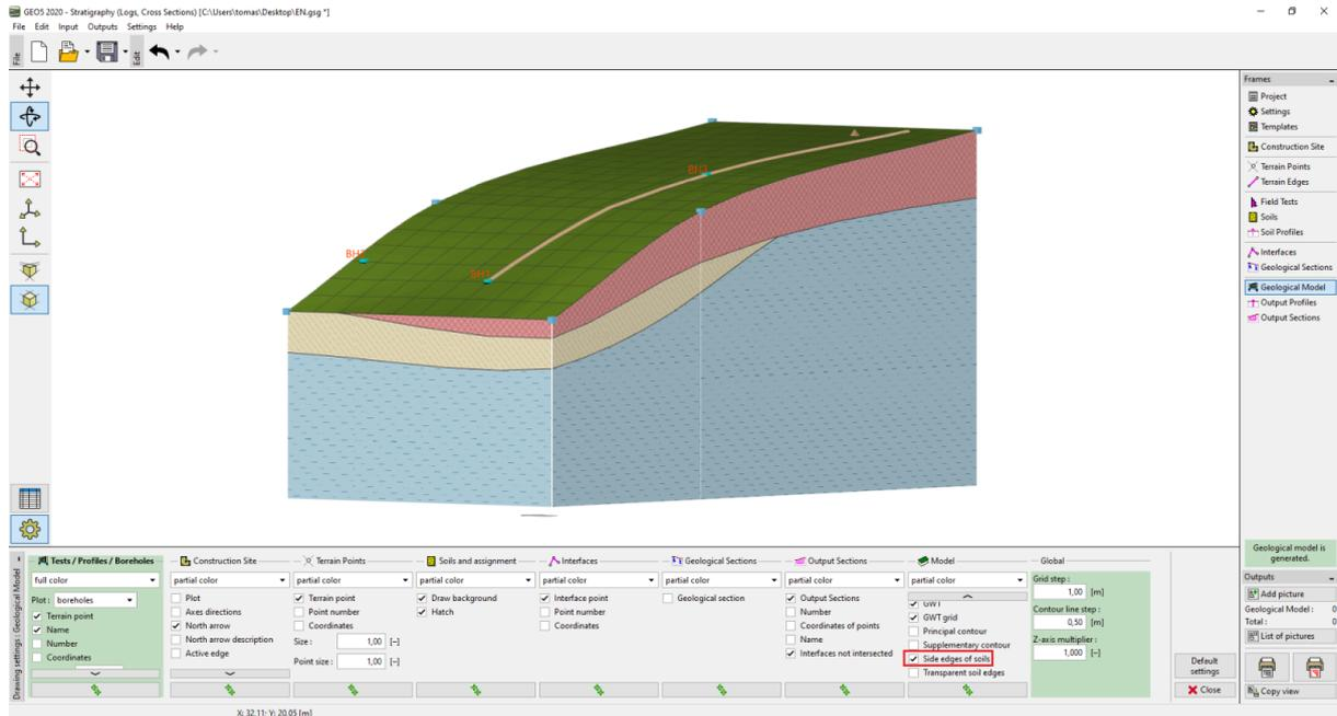
O modelo criado do subsolo pode ser modificado posteriormente através de novas sondagens, Por exemplo, vamos assumir que a camada de aterro na parte frontal será constante. Podemos realizar este ajuste ao adicionar uma nova sondagem.
