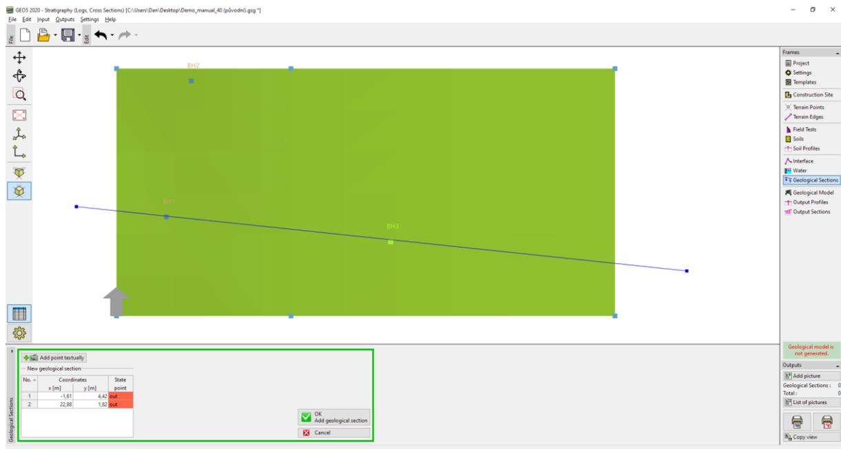
Após inserir, a secção será cortada de modo a ficar ajustada às dimensões do local de construção e é possível editá-la na caixa de diálogo respetiva – na secção “Topologia”. Aqui, vamos atribuir os ensaios que pretendemos exibir na secção geológica.
