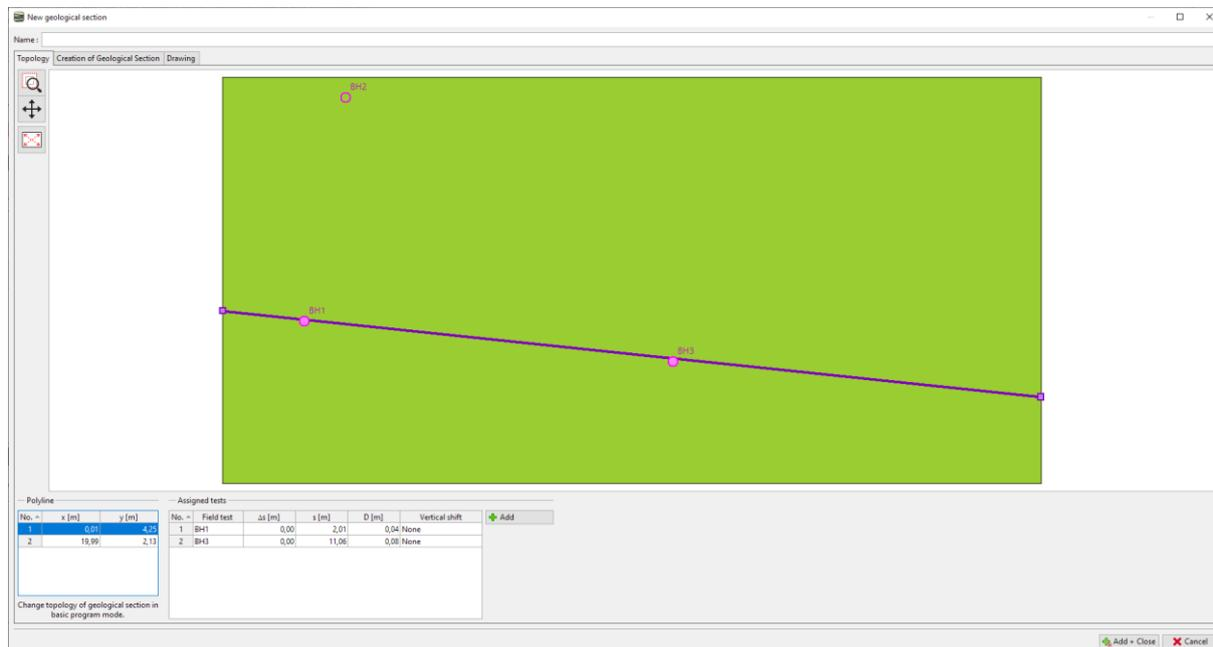
*Nota: As secções geológicas são um elemento básico na criação de um modelo 3D do subsolo. Aqui pode esboçar a sua percepção das camadas do solo. O modelo 3D passará a respeitar a sua atribuição. Os ensaios e perfis que não sejam atravessados pela secção também podem ser exibidos.*
