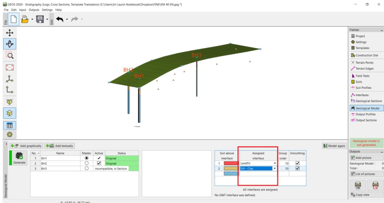
*Nota: A sondagem principal deve conter todos os solos (ou camadas de solo) existentes no modelo – mesmo que não se encontram fisicamente na posição da sondagem. Isto é comum quando criamos um modelo com uma lente ou falhas. Para mais informação, veja o Manual de Engenharia No. 41 – Modelação avançada no programa Estratigrafia.*
