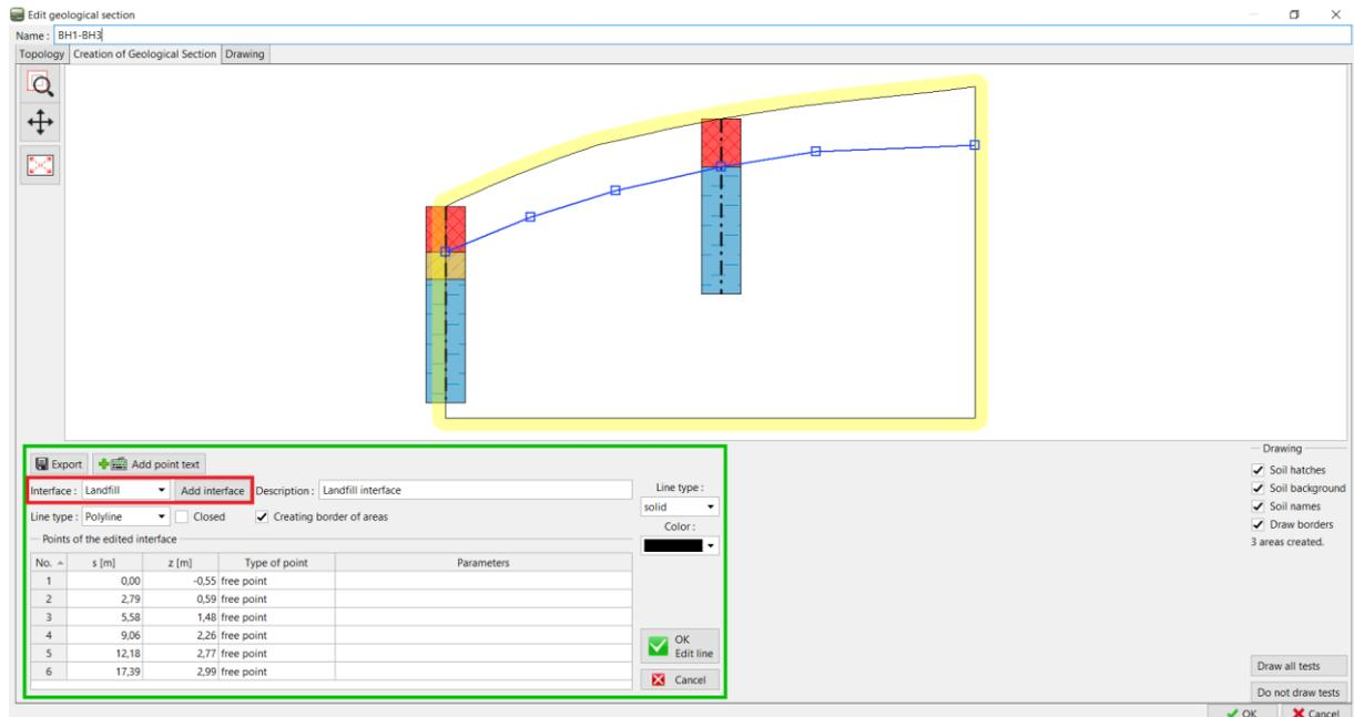
Vamos definir a interface entre silte e argila da mesma forma. Não se esqueça de criar uma nova interface “Silte – Argila”.
