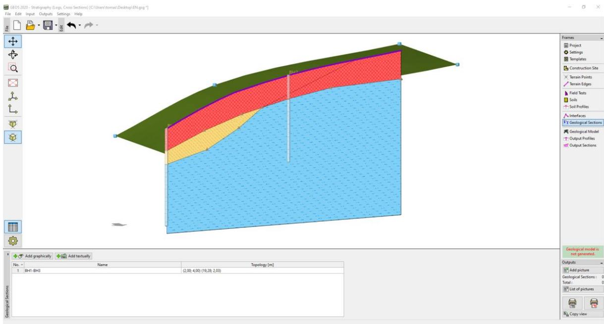
Na janela “Modelo Geológico”, vamos selecionar a “Sondagem Principal”. A sondagem principal determina o número e ordem dos solos no modelo. Esta sondagem deve conter todos os solos existentes no modelo. Na tabela, atribuímos as interfaces que definimos durante a criação da secção geológica.
